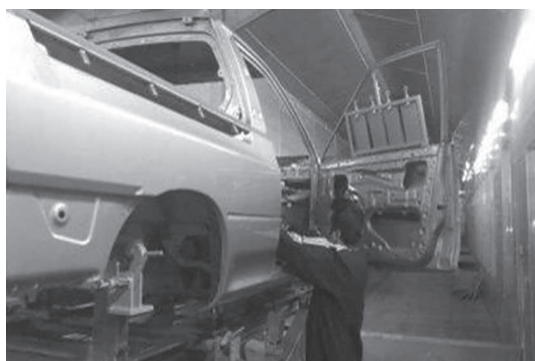
شکل ۴- نمایی از تست کیفی رنگ ED توسط کارشناسان مدیریت مهندسی تولید
