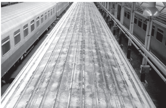
شکل ۴- زنگ زدگی و اکسید شدن سقف یک واگن (دسته اول)
