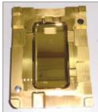
شکل ۷- اعمال نانو پوشش TiN بر روی قالب تزریق پلاستیک
