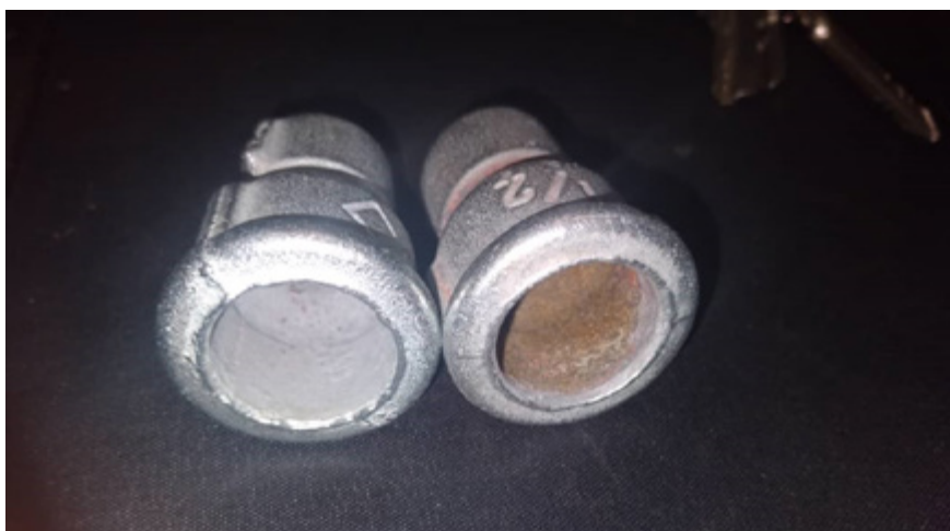
شکل ۵- قطعه سمت راست SCR و قطعه سمت چپ مربوط به رکتیفایر پالسی است.
