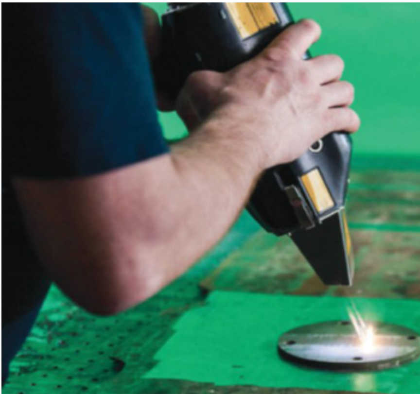
تمیز کردن لیزری دستی اغلب برای کاربردهای کم حجم که نیاز به انعطاف پذیری دارد استفاده میشود.
