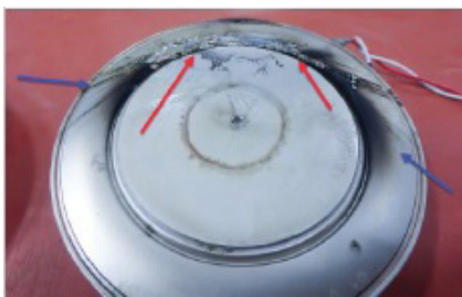
شکل ۱: آسیب SCR به دلیل توزیع نابرابر گرما
